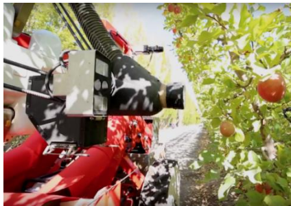
Figura 7 - Mecanismo de colheita da Abundant robotics [33].
