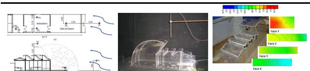
Figura 14: Modelo em escala reduzida do shed - Rede Sarah/Belém e parcial de resultado obtido..
