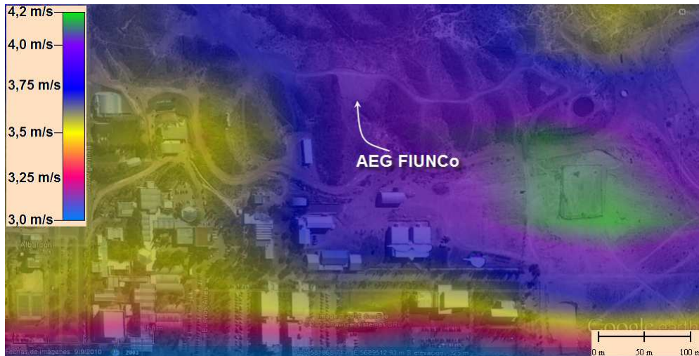
Figura 4: Velocidad media anual del viento a 10 m de altura sobre el nivel del suelo. Resolución espacial en ambas direcciones horizontales 93 m. Imagen de fondo: Google Earth.
