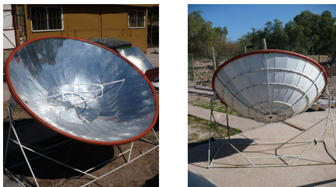
Figura 2: Superficie espejada y superficie posterior del concentrador SK14
