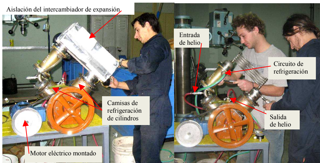
Figura 10: Motor montado con aislación del intercambiador de expansión (izq.).Detalle de las conexiones (der.).
