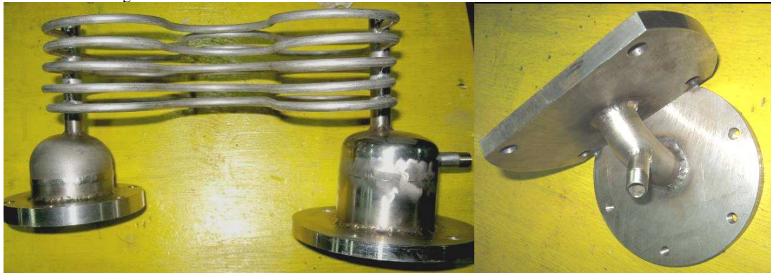
Figura 8: Conjunto brida-regenerador-intercambiador de expansión-tapa de cilindro caliente todo soldado en acero inoxidable.(izq.). Conjunto tapa de cilindro frío-uniión-entrada de gas-brida de enfriador soldados en acero (der.).
