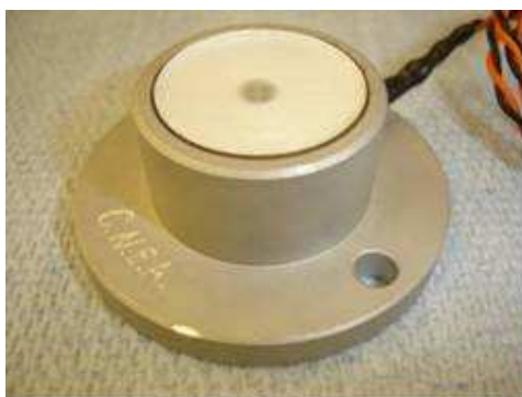
Figura 2. Radiómetro PAR desarrollado en el Grupo Energía Solar de la CNEA
