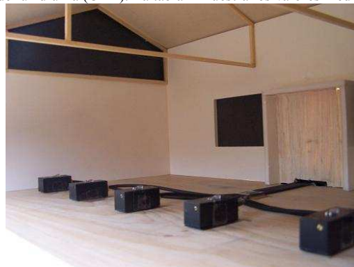
Figura 13 - Interior de maqueta con sensores de medición
