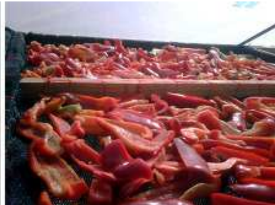
Fig. 10. Vista de las bandejas cargadas con pimientos cortados en cuartos en el interior del secadero.
