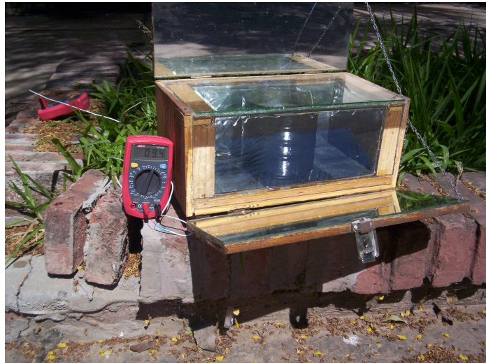
Figura N° 1: Imagen de la cocina solar con el recipiente de agua e instrumentos de medición
