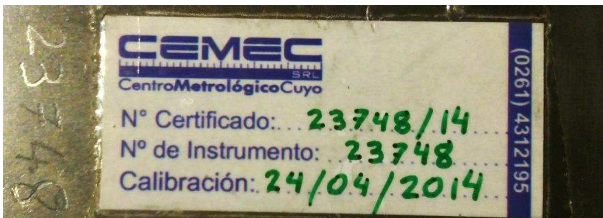
Figura 14: Etiqueta de certificado de calibración en el cuadrante de la llave torquimétrica.
