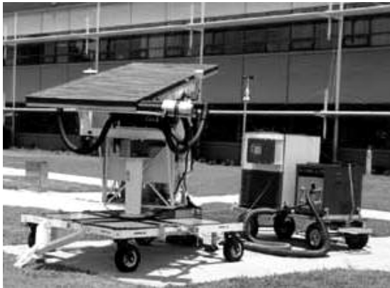
Figura 3: Equipamiento completo del banco de ensayos del Florida Solar Energy Center (FSEC), USA
