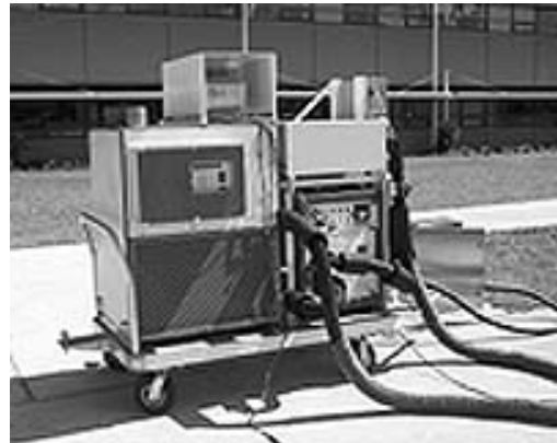
Figura 4: Carro o "movil" de apoyo que contiene el instrumental electrónico y el cuadro hidráulico, FESC
