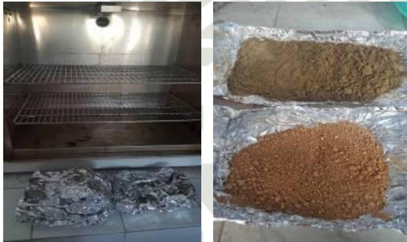
Sampel tanah untuk penentuan kadar air
