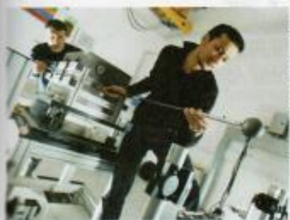
Calibração de um equipamento de radioterapia, para determinação da dosimetria (taxa de radiações) em uma exposição.
