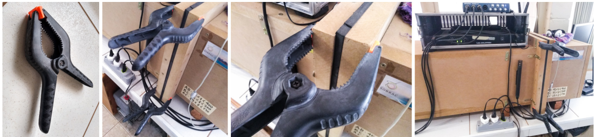
Figura 5.9: Adaptação efetuada para o acoplamento entre a caixa acústica e o corpo do tubo. Esquerda: um dos grampos de pressão utilizados; centro-esquerda: lateral do sistema de flange com dois grampos aplicados; centro-direita: detalhe para o grampo pressionando o sistema de flange preenchido pela borracha; direita: vista geral do acoplamento abrangendo parte do sistema eletroacústico e o termômetro instalado na lateral do tubo.
