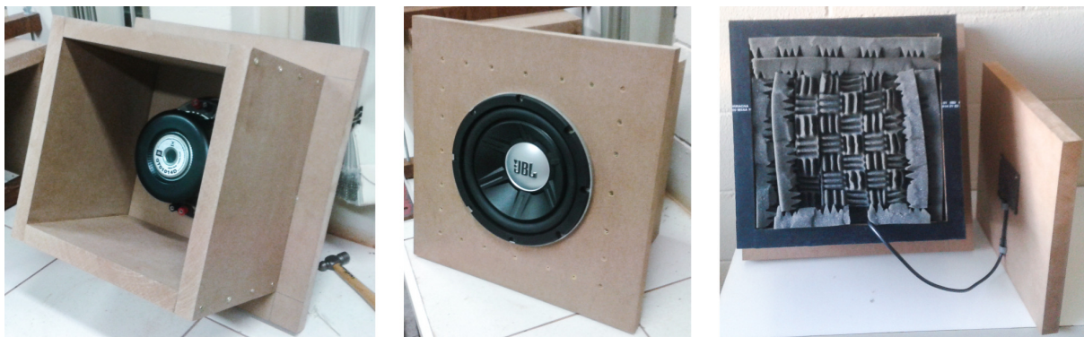
Figura 5.4: Fotos da caixa acústica em montagem. Esquerda: interior da caixa visto pela traseira aberta; centro: vista frontal; direita: interior da caixa preenchido com espuma acústica, com detalhe para o painel conector instalado na traseira.
