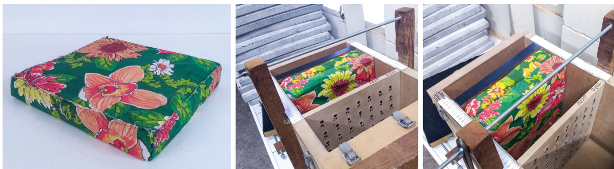
Figura 6.6: Fotos da placa resistiva isolada (esquerda) e aplicada à uma amostra (centro e direita).
