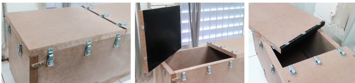
Figura 5.6: Fotos da porta referente à cavidade de amostra. Esquerda: porta fechada sem o acionamento dos fechos de pressão; centro: porta aberta com detalhe para a borracha aplicada na parte inferior; direita: porta aberta com detalhe para a borracha aplicada na lateral.
