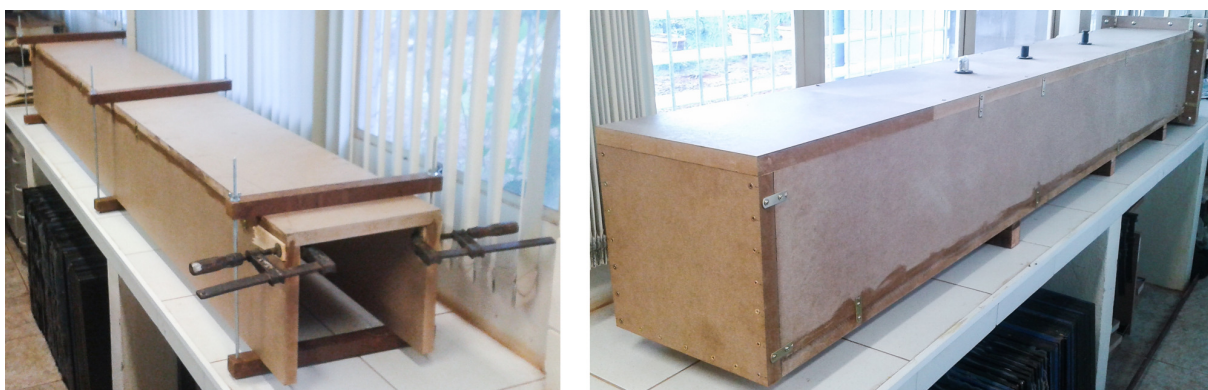
Figura 5.2: Fotos do corpo do tubo de impedância, tiradas durante (esquerda) e após (direita) a primeira etapa de construção.
