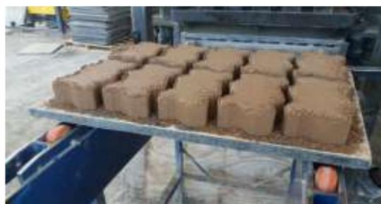
Figura 2: Amostra de pisos intertravados fabricados na empresa Pavicon (Hortolândia-SP).
