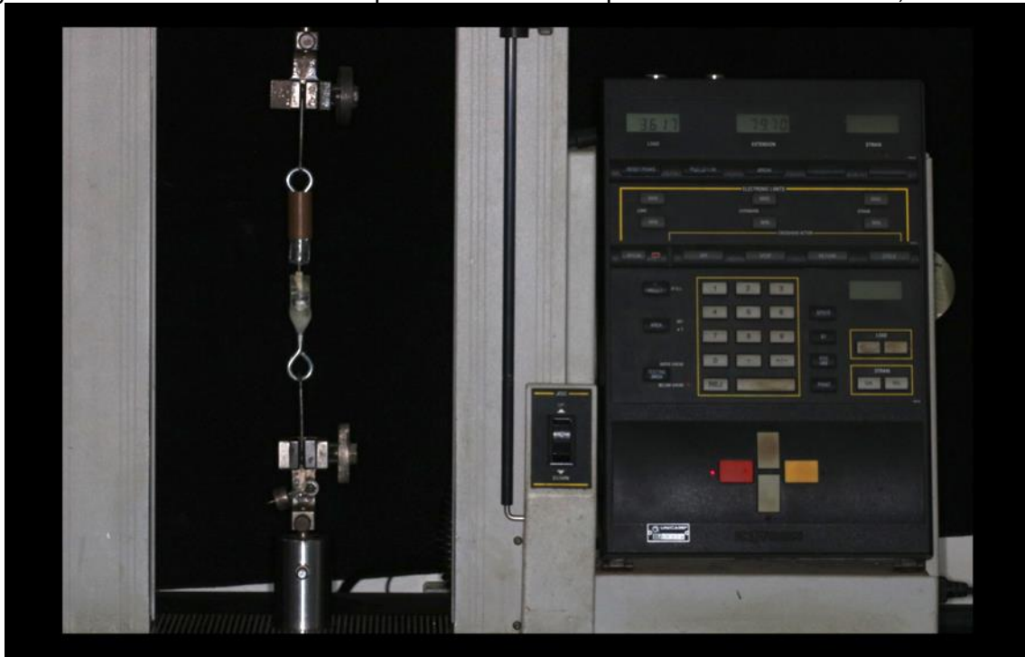
Figura 14 – Amostra devidamente posicionada na máquina de ensaio universal, Instron 4411
