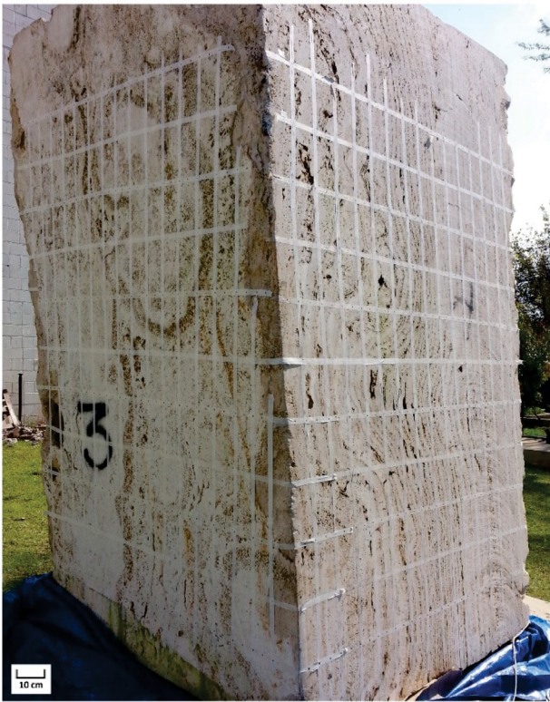
Figura 1. Amostra de travertino T-block e malha regular construída em suas faces. A face esquerda representa a seção basal, enquanto a direita, o perfil vertical.
