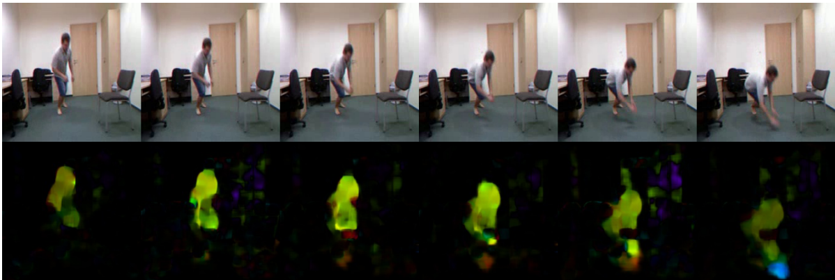
Figura 2.4: Exemplos de fluxo óptico. Cada fluxo óptico foi extraído entre o quadro ilustrado e o próximo na sequência. A cor do pixel indica a direção do movimento e o seu brilho indica a magnitude.
