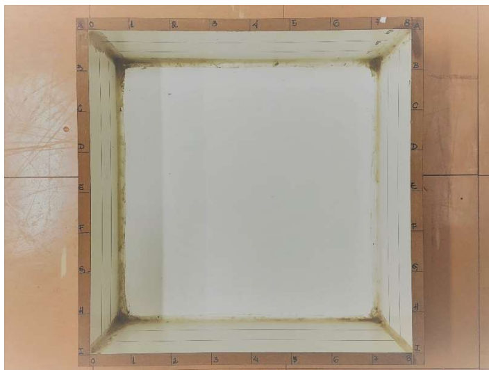
Figura 3.2 – Caixa utilizada na avaliação da sensibilidade às variações da massa específica aparente.
