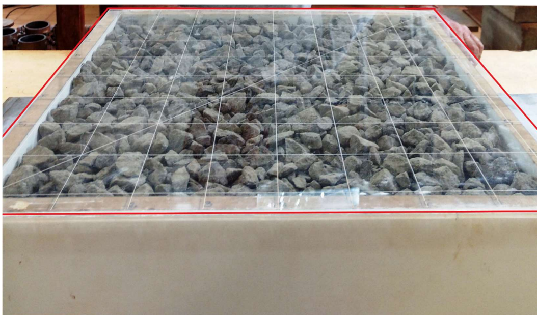
Figura 3.11 – Gabarito em acrílico transparente confeccionado para garantir o espaçamento constante entre as linhas de levantamento e o alinhamento da antena quando da execução do ensaio.
