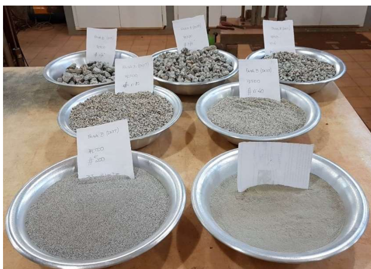
Figura 4.2 – Amostras de material fracionado com auxílio de um agitador mecânico de peneiras.
