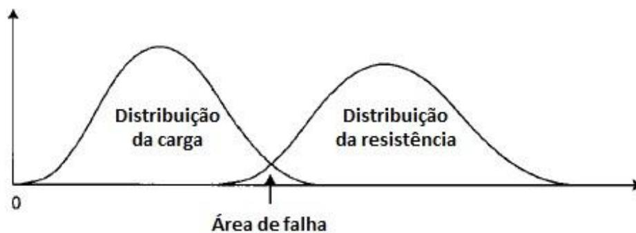
Figura 3.8: Distribuições de carga e resistência. (Rausand, 2004).
