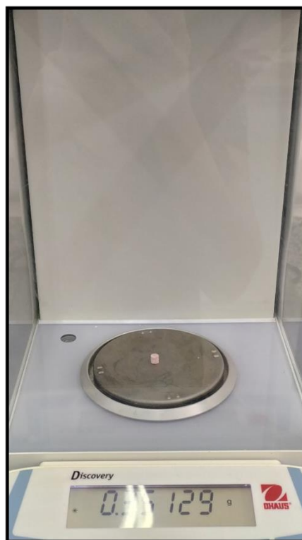
Figura 4. Aferição de massa de um cilindro de guta-percha.
