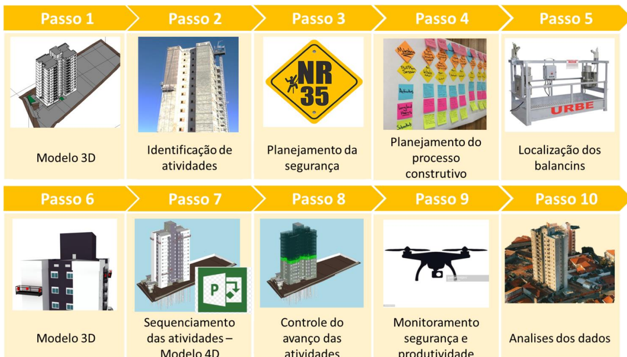
Figura 20. Primeiros passos adotados para o planejamento e controle da segurança com BIM
