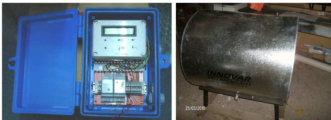
Figura 12 –(izq) Unidad de Freno Aerogenerador 1 (aún no instalada) y (der) – Sistema Termosolar adquirido 03-2010 a INNOVAR SRL (San Luis) – Los datos de ambos equipos llegan al SISMED/C vía RS485.
