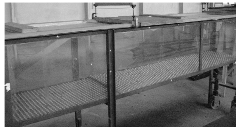
Figura 4: Túnel de viento y dispositivos de simulación de la capa límite.
