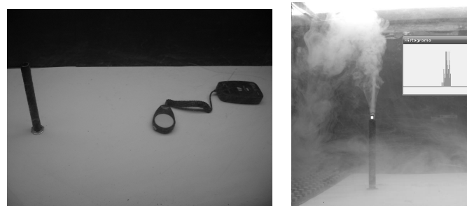
Figura 6: Escenas durante el acondicionamiento y al obtener la media de la escala de gris a la salida de la chimenea.
