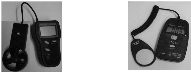
Figura 5: Imagen del anemómetro para control de velocidad y del luxómetro para acondicionar la escena.
