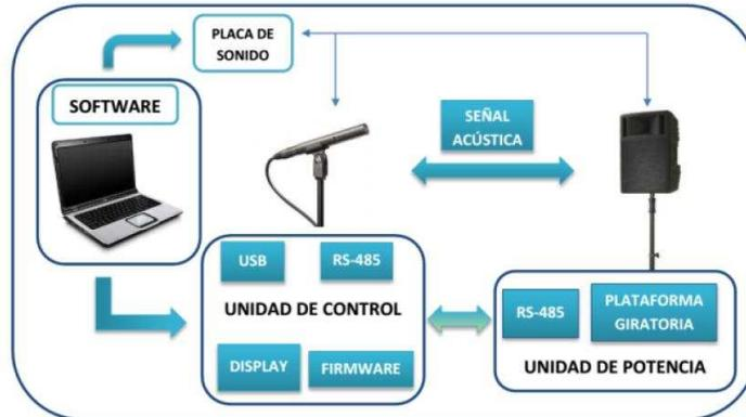
Figura 1: Diagrama de bloques del SAMDir v2.0.
