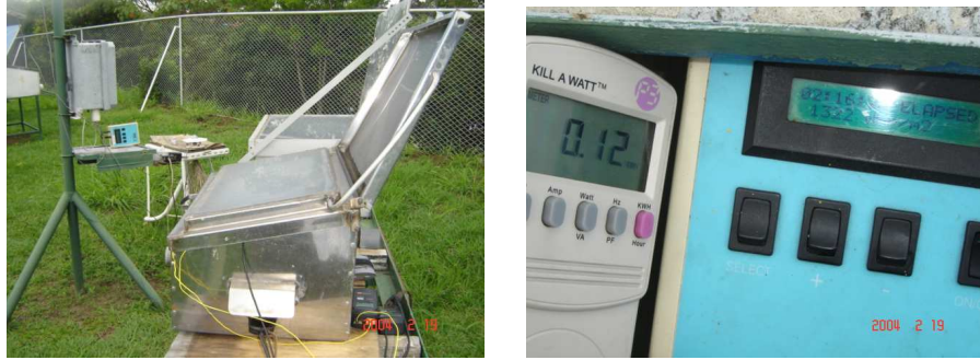
Fig. 7. Medición de energía solar y eléctrica integrada durante el secado, en el Secador Híbrido
