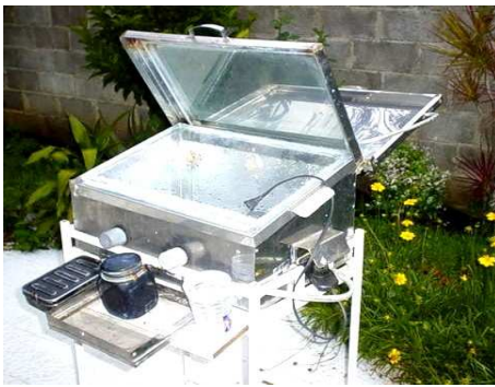
Fig.2a (esquema), 2b y 2c (modo de cocción y pasterización, Procesador Híbrido de Alimentos. (1) Placa eléctrica, (2) Entrada de energía eléctrica y termostato, (3) Reflector, (3A) Varilla para ajustar ángulo, (4) Entradas de aire externo, (5) Salidas de aire húmedo, (6) Caja exterior, (7) Medidor de energía eléctrica, (8) Recolector de agua destilada, (13) Canoa.
