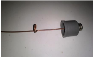
Gambar 7 Pemasangan Elemen Driven ke-Konektor
