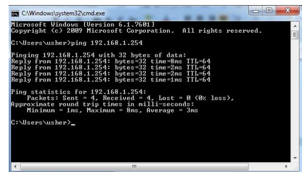
Gambar 11 PING ke perangkat Router
