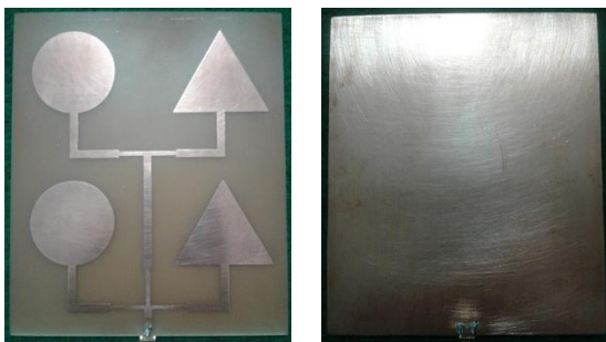
Gambar 9. Antena array mikrostrip patch triangular-circular yang telah di pabrikasi
