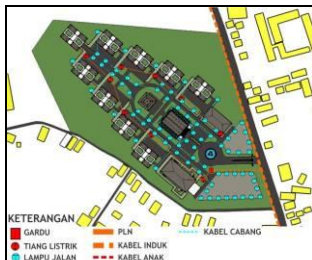
Gambar 19: Skema Kelistrikan Pada Perancangan Kawasan Politeknik Kapuas Hulu
