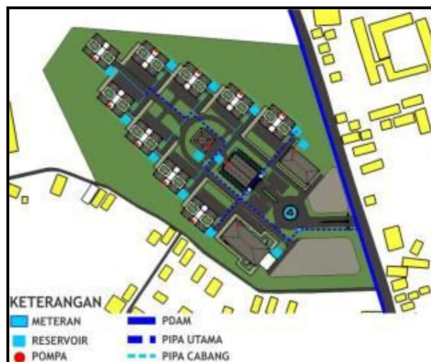
Gambar 15: Konsep Utilitas Air Bersih Pada Perancangan Kawasan Politeknik Kapuas Hulu
