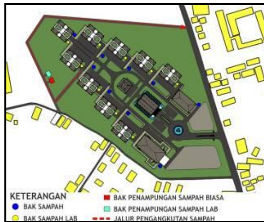
Gambar 20: Skema Persampahan Pada Perancangan Kawasan Politeknik Kapuas Hulu
