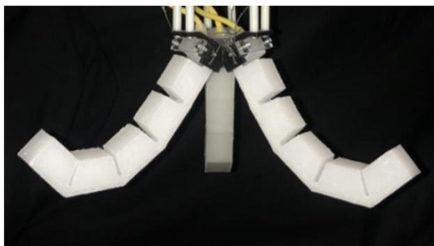
図7 軟体動物型ソフトマニピュレータ (空気圧駆動型)
