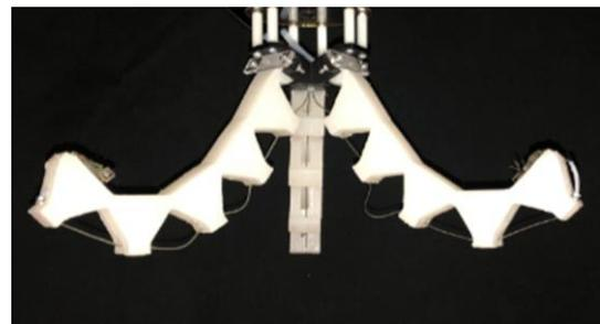
図3 軟体動物型ソフトマニピュレータ（腱駆動型）
