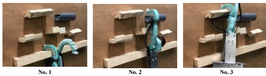
Fig. 23 障害のある壁の登攀 (パターン 2)
