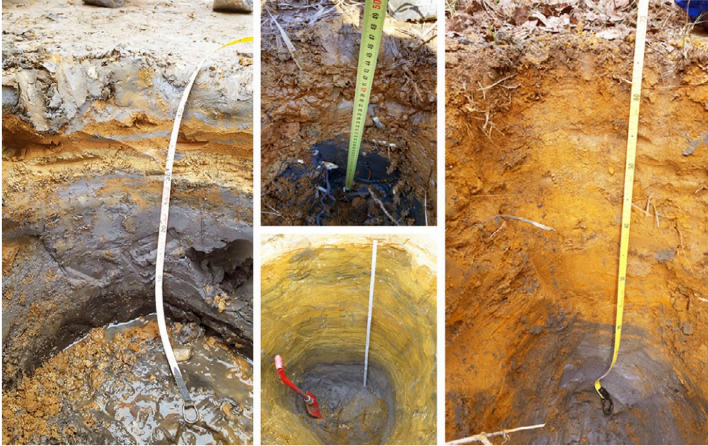
Kuva 8. Suljettujen ja peittämättömien (tai lähes peittämättömien) rikastushiekka-alueiden rikastushiekan sisältämät mineraalit muodostavat hapettumisesta johtuvaa kerroksellisuutta (© A. Tornivaara).
