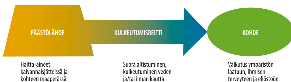
Kuva 4. Haitan ja riskin muodostuminen suljetuilla ja hylätyillä kaivosalueilla (mukailtu: YM 2014a).
