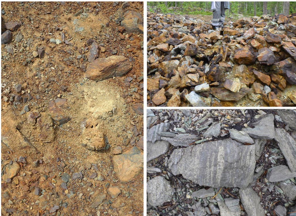
Kuva 7. Vasemmassa kuvassa rapautunutta sivukiveä Särkiniemen kaivoksesta ja oikeanpuolisissa kuvissa rapautunutta sivukiveä (yllä) sekä tuoreempia malminetsinnässä irrotettuja sulfidipitoisia kiviä (alla) Tipasjärven Kiisulan hylätyltä kaivosalueelta (© A. Tornivaara).
