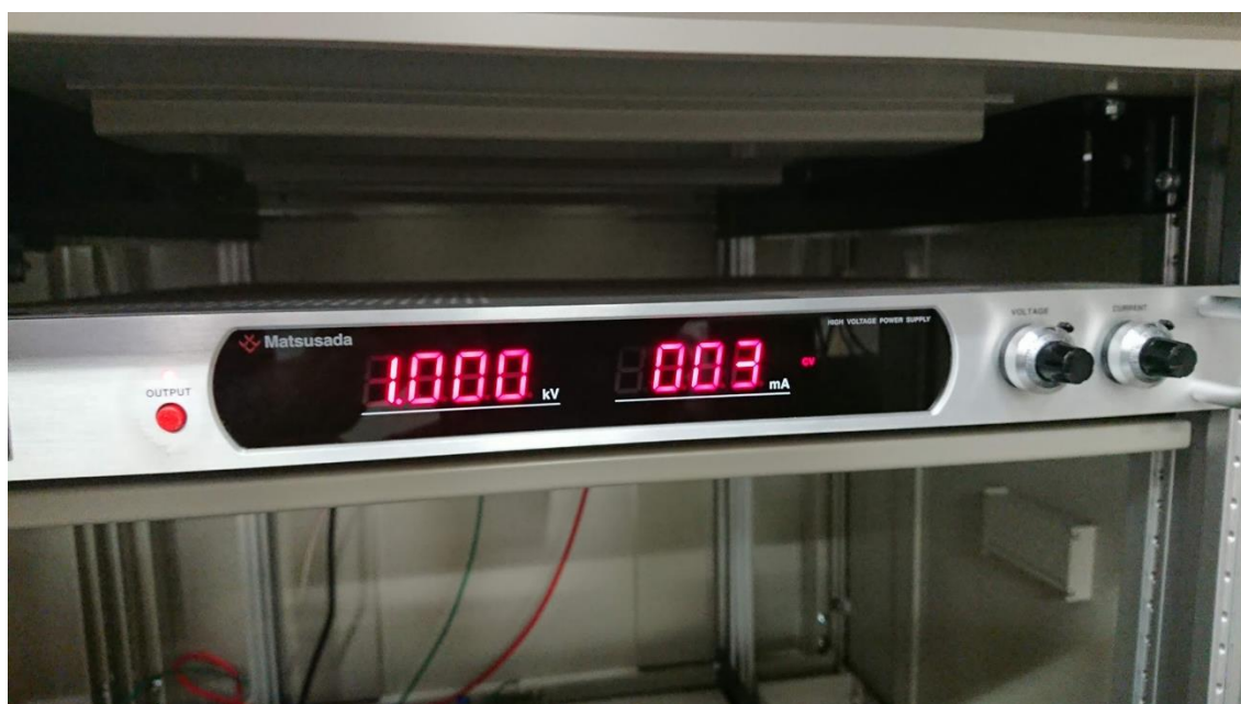
図 4-17 1kV の絶縁耐性評価時の高電圧供給装置の様子
