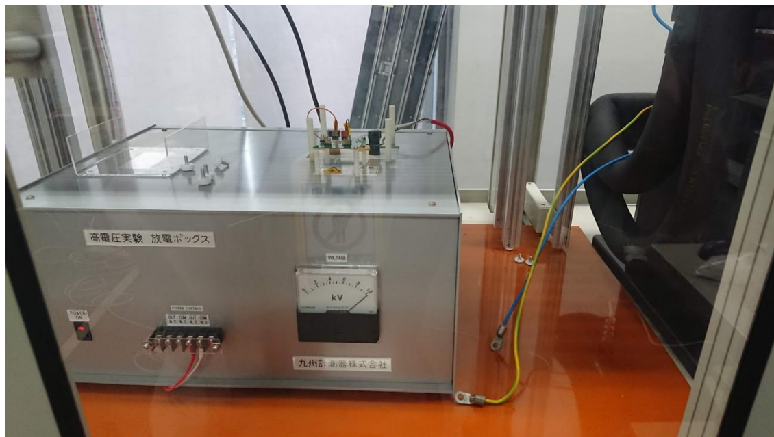
図 4-16 1kV の絶縁耐性評価時の高電圧実験放電ボックスおよび測定回路の様子
