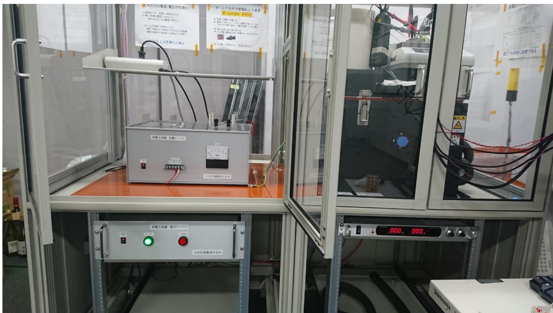
図 4-14 絶縁耐性測定の測定環境の全体写真
