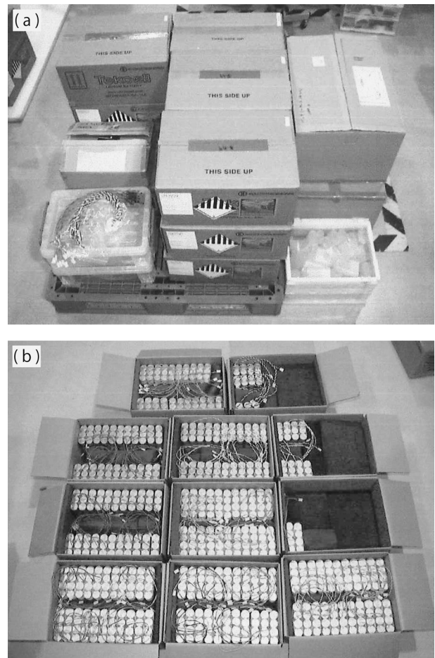
図 7. 2018年7月に実施した外部委託の作業時の様子. 専用ケースを用いた2~4直列の組電池計196個が製作された. (a) 作業前の組電池構成部品. (b) 製作された組電池. 作業完了報告書から引用.
