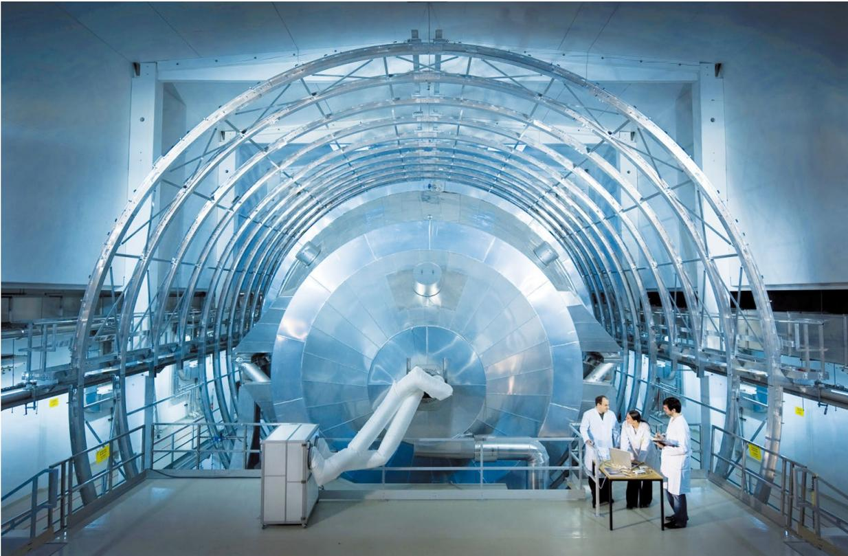
**Das Innere des Hauptspektrometertanks ist mit einer doppelagigen Drahtelektrode (etwa 23 000 Drähte) zur Untergrundabschirmung und Feinformung des elektrischen Feldes ausgekleidet. Außen umgibt den Tank ein „Hamsterkäfig“ aus Magnetspulen, um das Magnetfeld passgenau einzustellen und zudem den Einfluss des Erdmagnetfeldes kompensieren zu können.**
