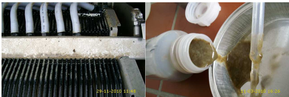
Abb. 3-7: Gelartiger Belag auf Membran und Einbauten
