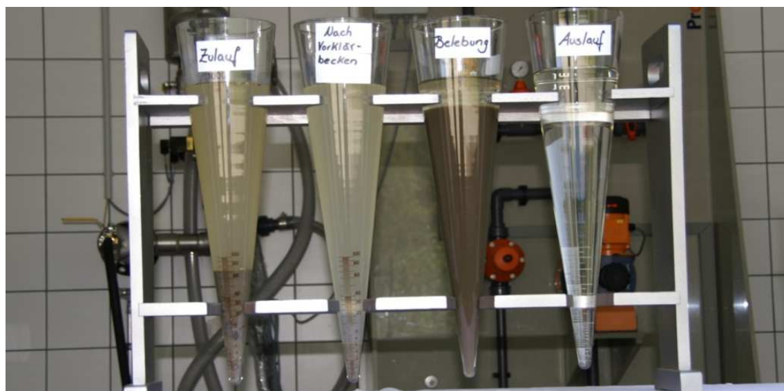
Abb. 3-5: Abwasser der einzelnen Behandlungsstufen der MBR-Anlage
