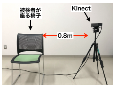
図 6.6: 計測時の椅子と Kinect の位置
