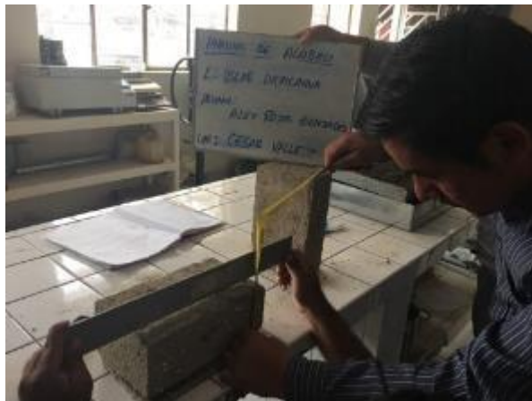
Figura 20: Alabeo de concreto artesanal
