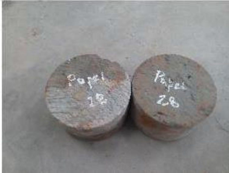
Figura 23: Núcleos de concreto en losas curadas con papel húmedo.
