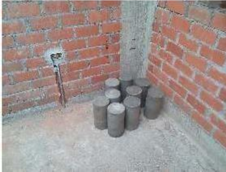
Figura 17: Probetas de concreto a ensayar.
