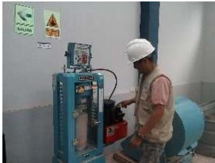
Figura 30: Aplicación de carga con compresora, para ensayo de resistencia a la compresión.
