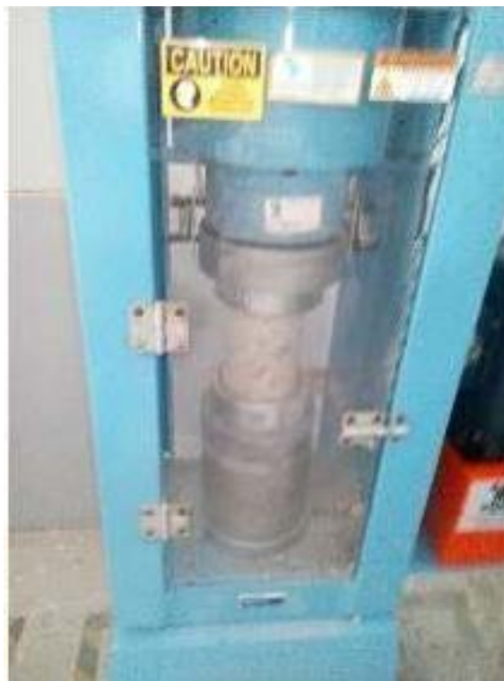
Figura 28: Protección contra partículas sueltas durante el ensayo de resistencia a la compresión.
