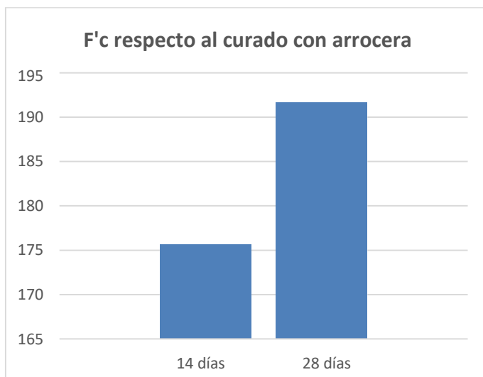
Figura 3: Gráfica de comparación entre las medias de la resistencia de los testigos extraídos con diamantina a 14 y 28 días de probetas de concreto F'c : 210 Kg/cm 2 , curada con arrocera.
