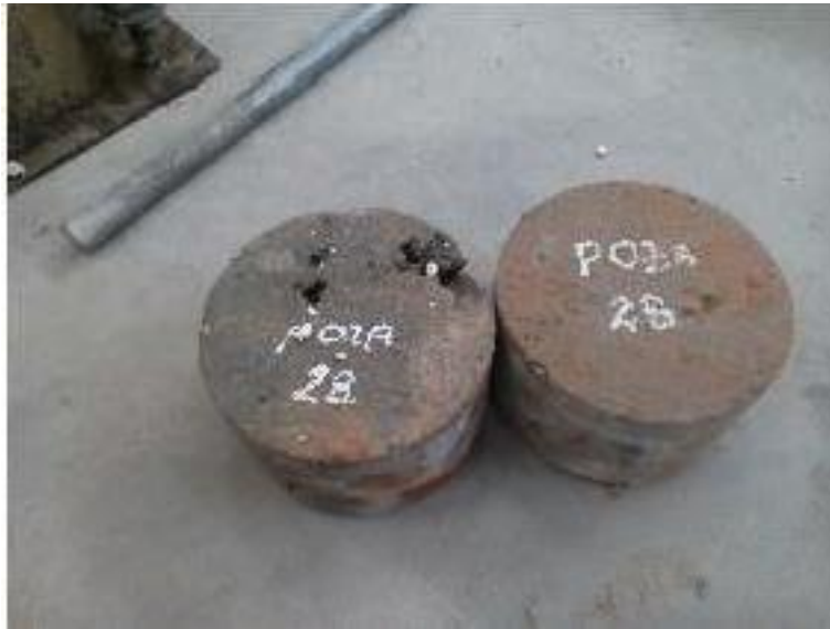
Figura 24: Núcleos de concreto en losas curadas con arrocera.
