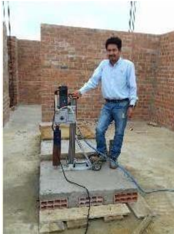
Figura 22: Maquina Diamantina extractora de Núcleos de Concreto
