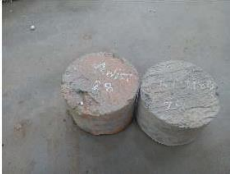
Figura 25: Núcleos de concreto en losas curadas con aditivo.
