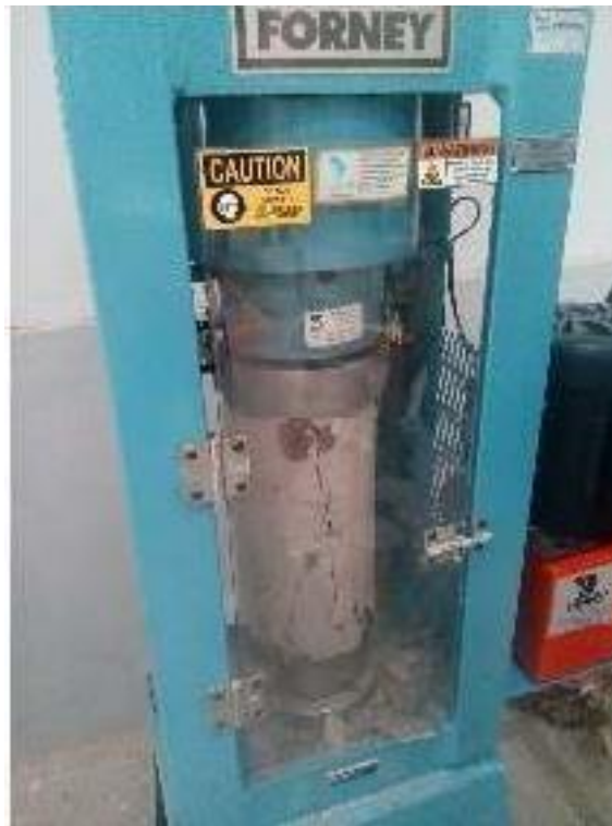
Figura 26: Rotura de probetas.
