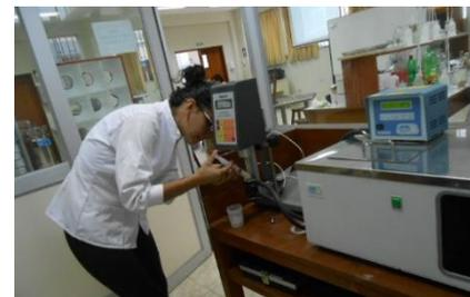
Imagen N°6 Colocación de la muestra en el viscosímetro
