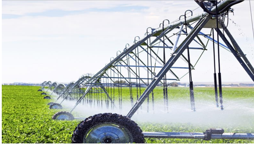
Figura 21: Pivot accionado por motor eléctrico
