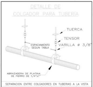
DETALLE DE COLGADOR PARA TUBERÍA SEPARACION ENTRE COLGADORES EN TUBERIAS A LA VISTA 3/4" 1" 1 1/4" a 2" 2 1/2" a 4" ESPACIMIENTO ENTRE COLGADORES 1.00m 1.50m 2.00m 2.50m
