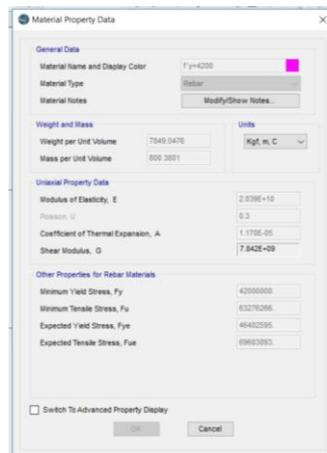
Fig. 3.10 Definiendo el acero  $f'y=4200 \text{ kg/cm}^2$
