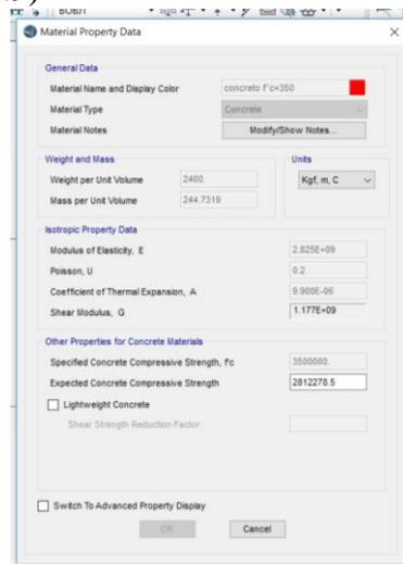
Fig. 3.9 Definiendo concreto  $f'c=350 \text{ kg/cm}^2$
