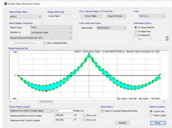
Fig. 3.76 Diagrama de momentos de la viga exterior izquierda
