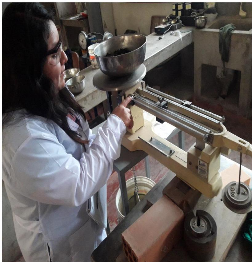
*Foto 10: Hallando peso específico, peso en volumen – peso en el aire*
