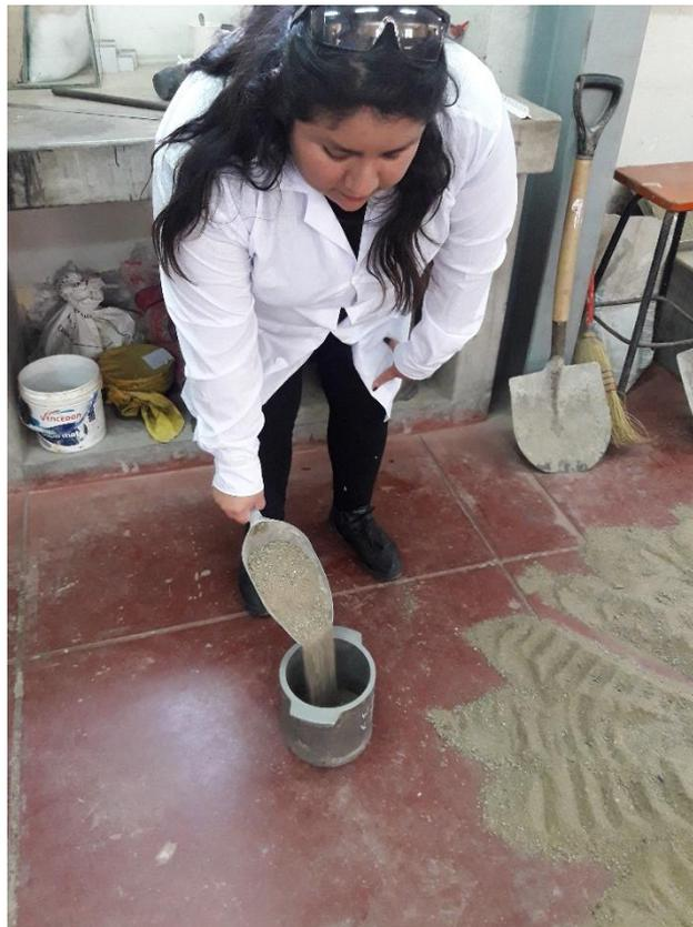
**Foto 14: Ensayo peso unitario - agregar sin ejercer fuerza (2 ensayos) - ARENA**
