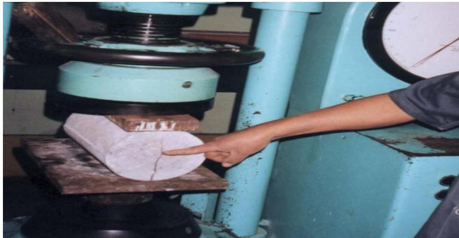
Figura 8: Ensayo de tracción indirecta
