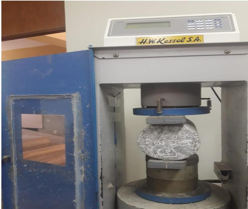
*Foto 22: Ensayo de resistencia a la tracción indirecta para testigo con adición de viruta reciclada*
