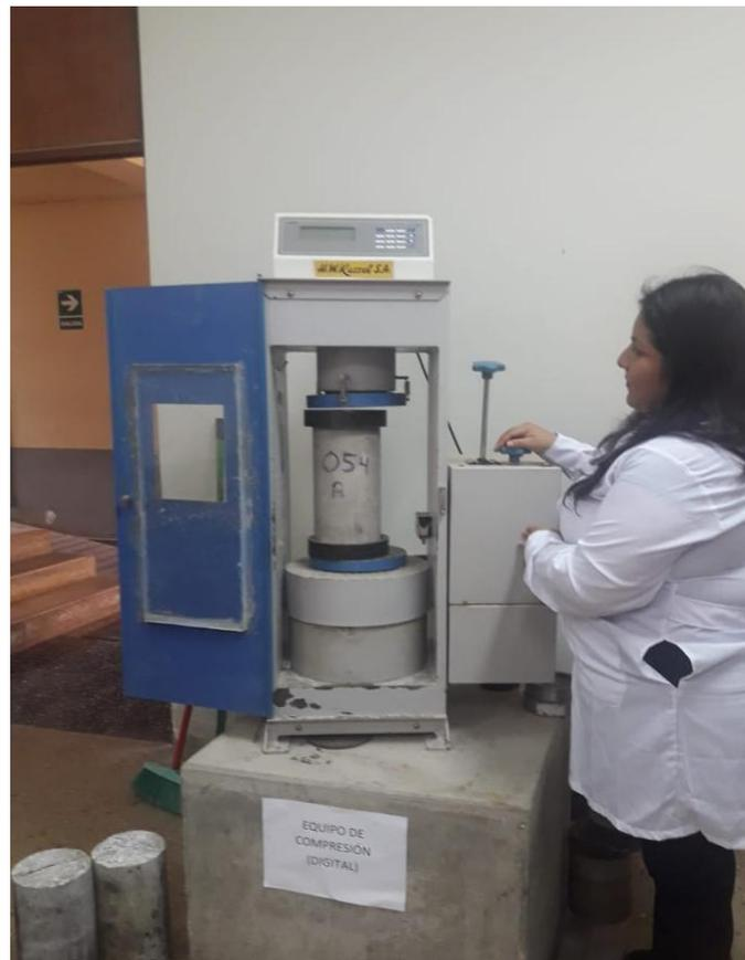
***Foto 21: Ensayo de resistencia a la compresión para testigo con adición de viruta reciclada***
