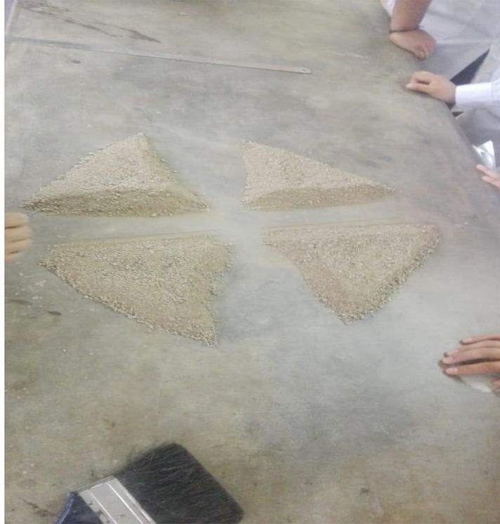
**Foto 15: Aplicando método del cuarteto para muestras de p.e , volumétrico y ensayo por humedad**
