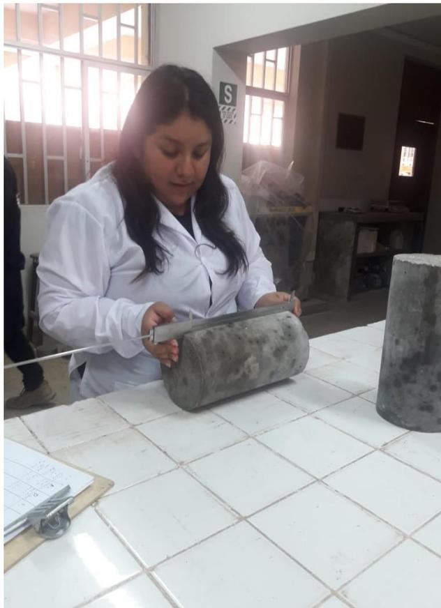
*Foto 19: Identificación de la altura de la muestra y/o testigo*
