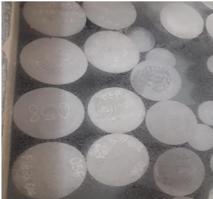
**Foto 16: Proceso de curado de los testigos preparados para ensayos mecánicos del concreto**
