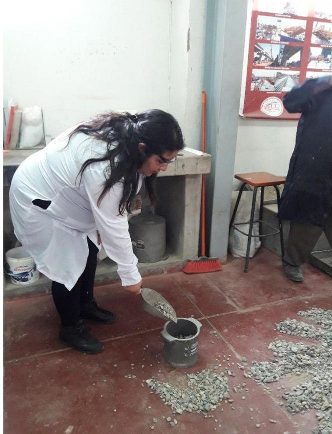
**Foto 13: Ensayo peso unitario - agregar sin ejercer fuerza (2 ensayos) - PIEDRA**
