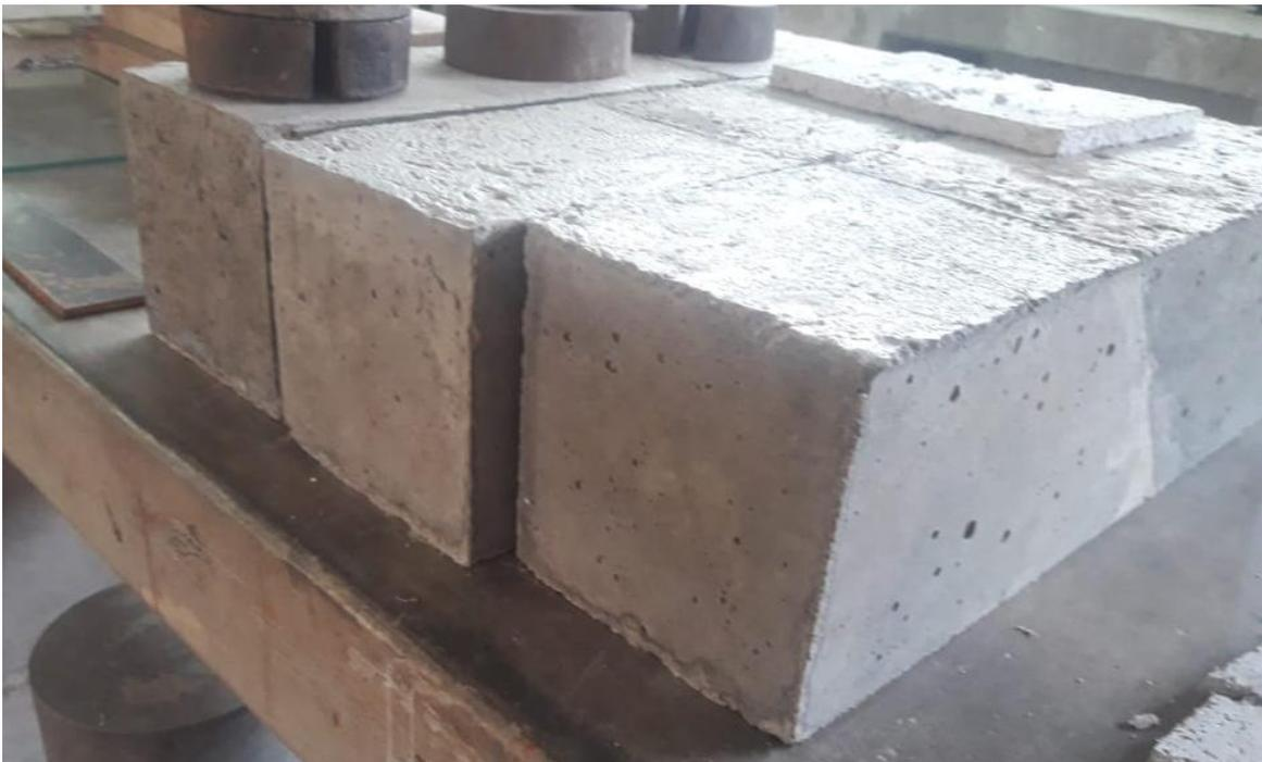
*Foto 17: Testigos para ensayos de resistencia a flexión a 28 días de edad*
