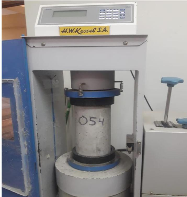
***Foto 20: Ensayo de resistencia a la compresión para testigo con adición de viruta reciclada***
