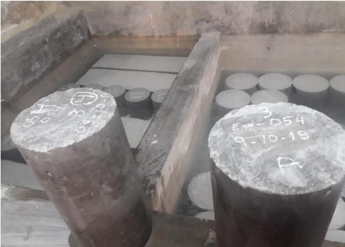
*Foto 16: Testigos para ensayo de compresión a 28 días de edad*
