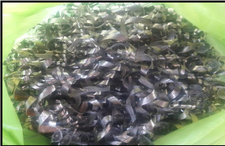
*Figura 3: Viruta de acero obtenido de los desechos de empresa metalmecánica*
