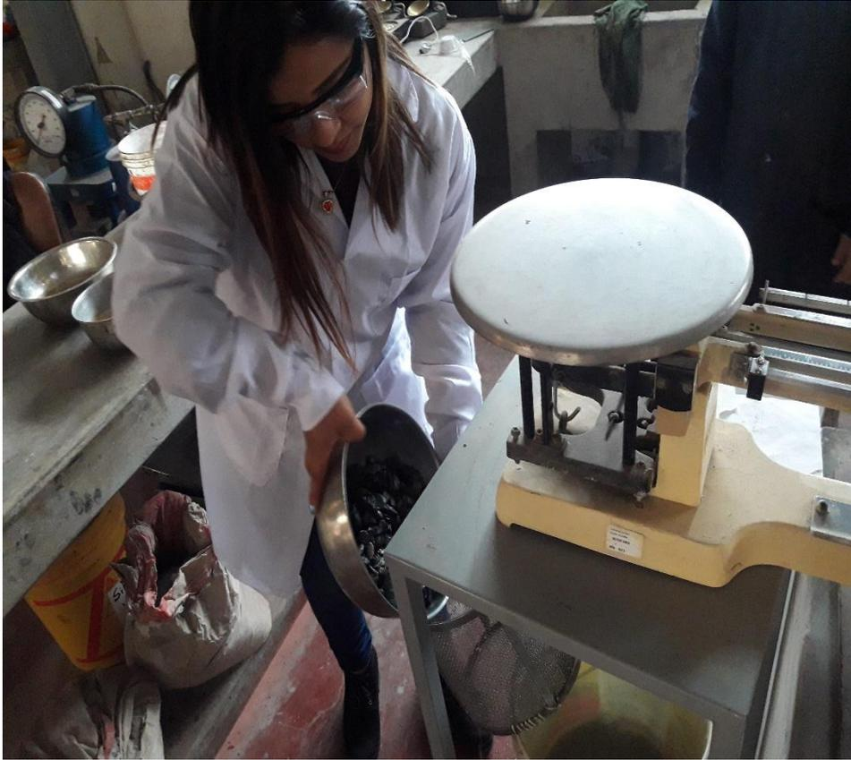
*Foto 11: Hallando peso específico, peso sumergido*
