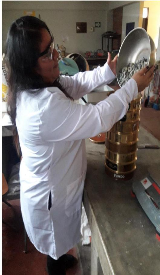
*Foto 05: Trabajos de lab. Para análisis de ensayos granulométricos*
