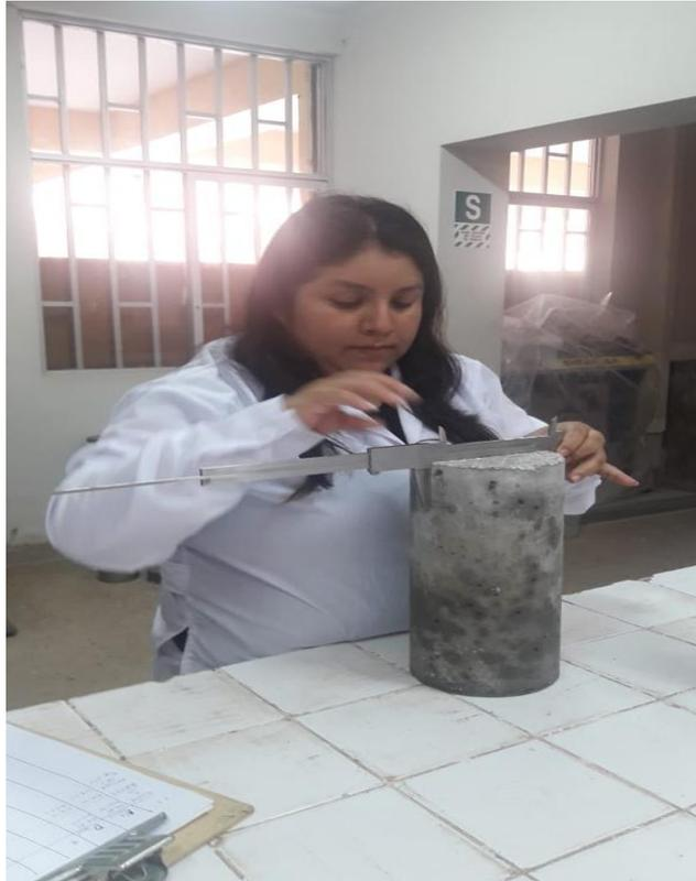
*Foto 18: Identificación del diámetro de la muestra - testigo*
