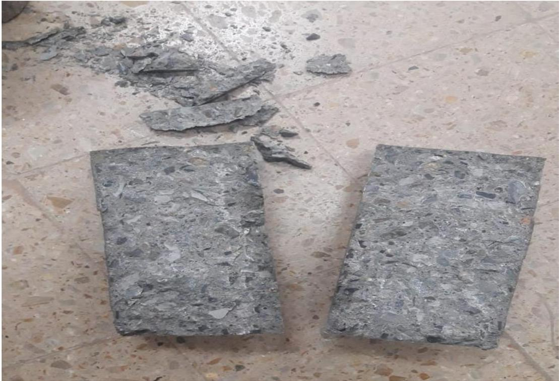
***Foto 24: Testigo destruido luego de someterse a prueba de ensayo de tracción***
