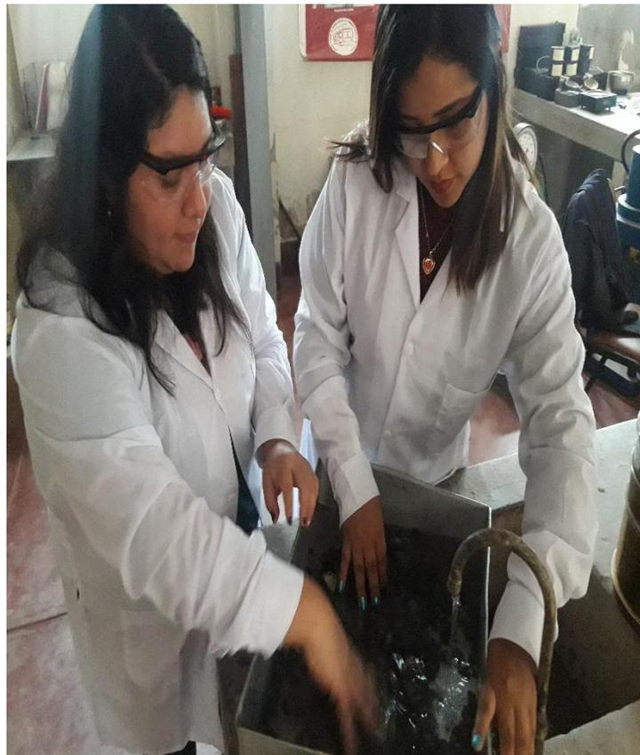
***Foto 08: Lavar material de piedra chancada para luego proceder a ensayo de P.E –
