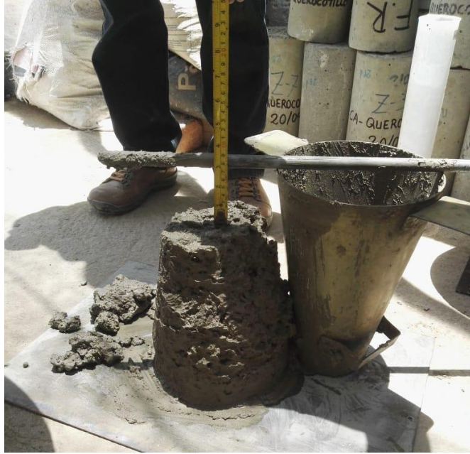
Figura 24. Prueba de SLUMP de mezcla.
