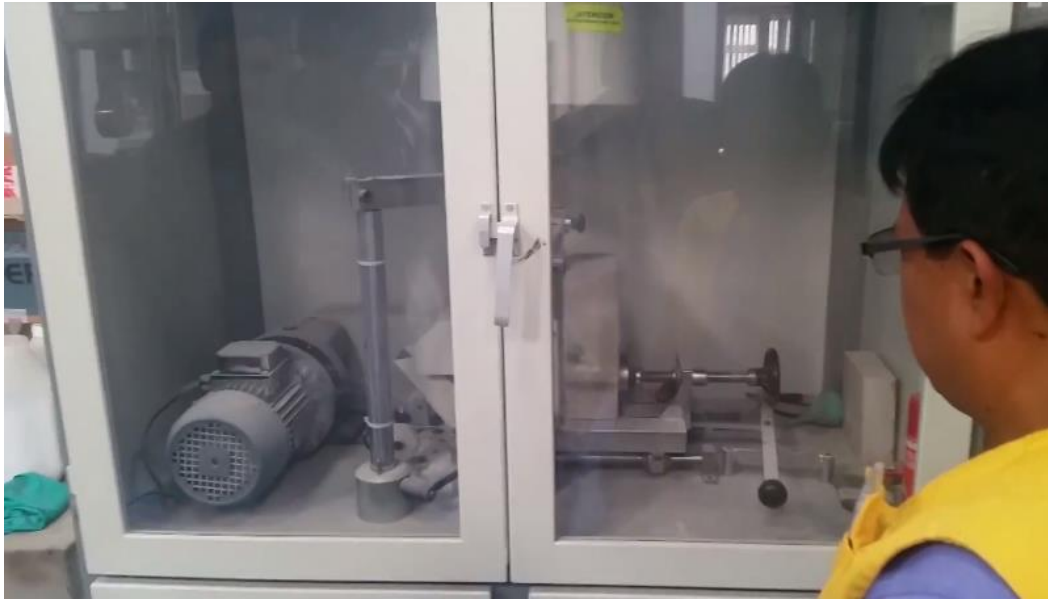
Figura 37. Adoquín dentro de máquina para ensayo de desgaste por abrasión.
