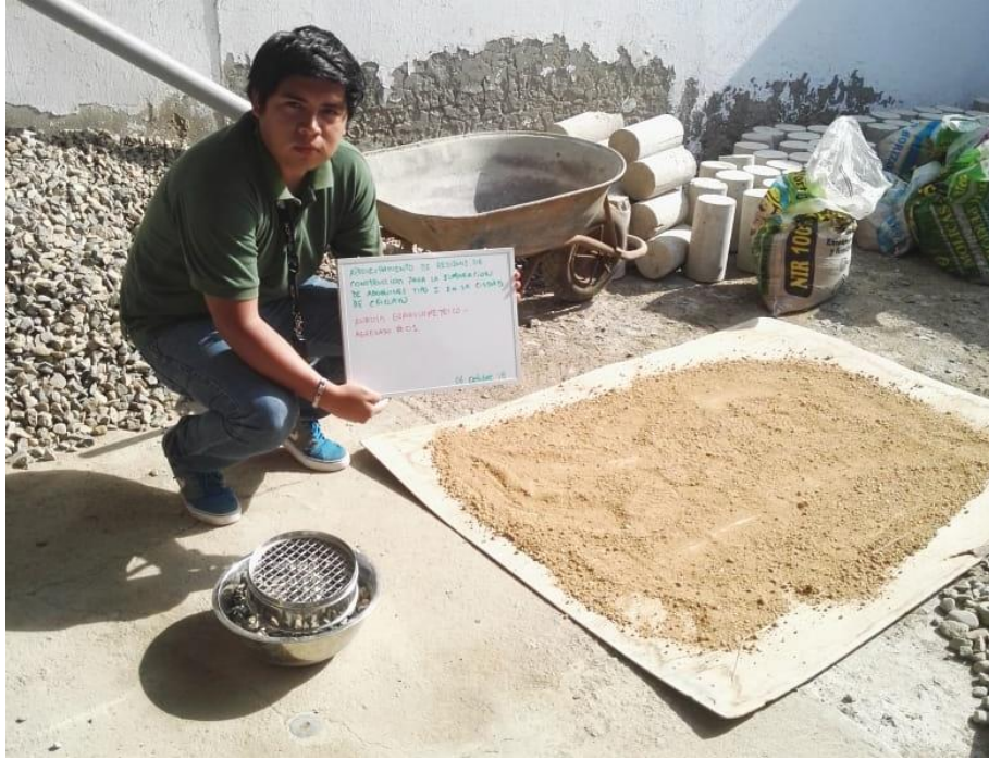
Figura 08. Cuarteo agregado fino cantera La Victoria.
