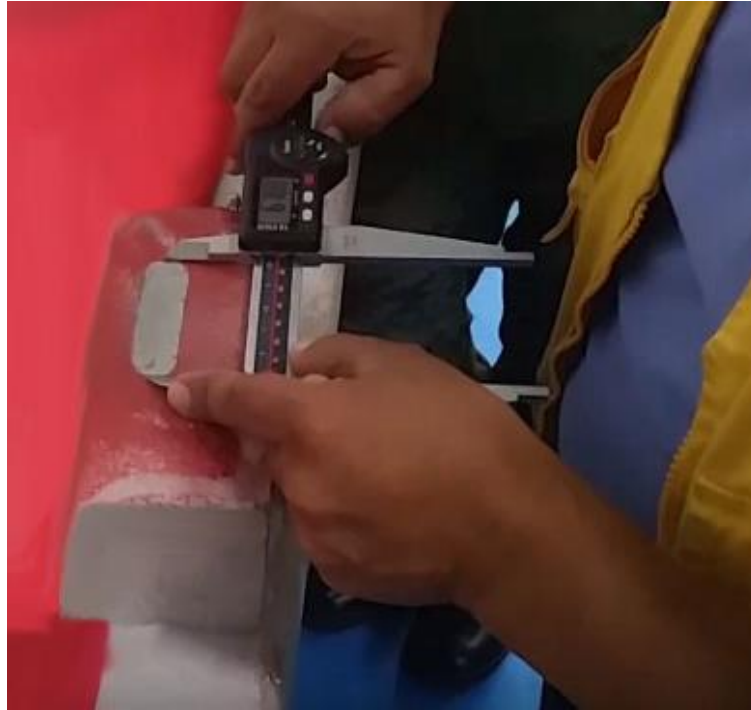
Figura 39. Medida de la huella con la regla milimétrica digital.
