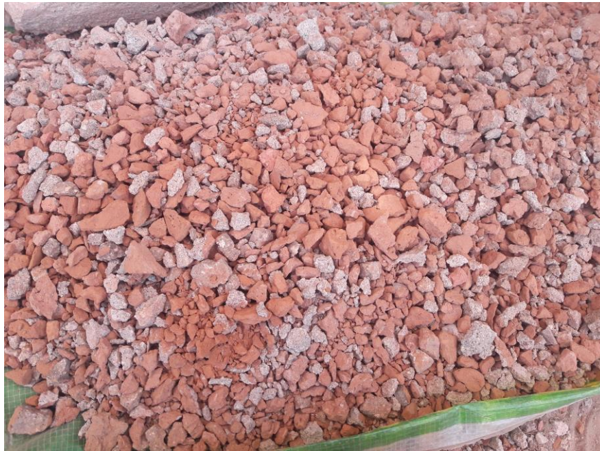
Figura 06. Resultado de la trituración de las muestras previamente seleccionada.
