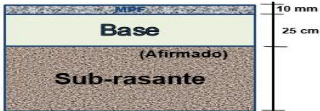
Figura 14: Sección del pavimento (Fuente: elaboración propia)
