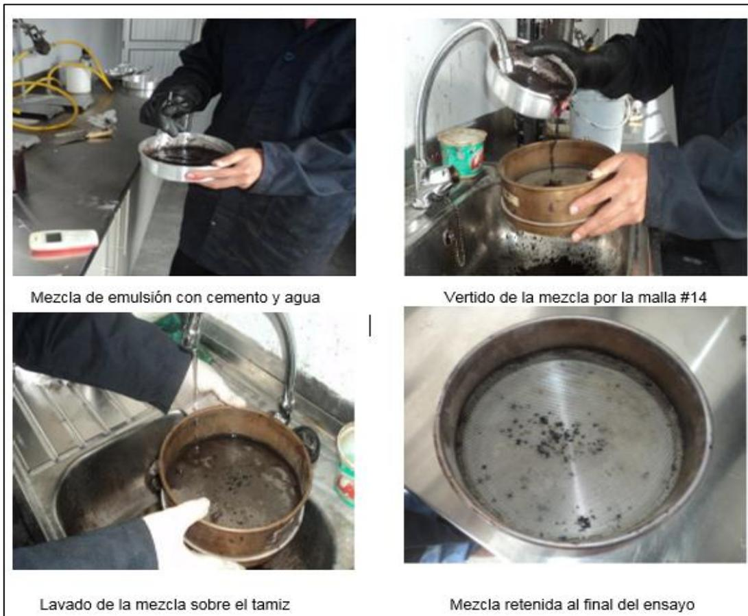
Figura 23: Ensayo de Mezcla con Cemento (Fuente: Emulsiones Asfálticas Ing. Gustavo Rivera)
