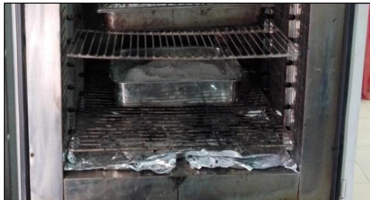
Figura 27: Secado en horno del agregado
