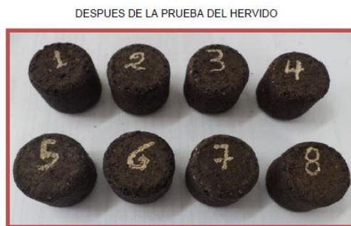
Figura 37: Muestras ensayadas después del hervido (Fuente: TDM 2017)
