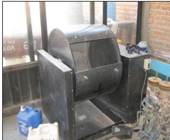
Figura 17: Equipo de Abrasión, ensayo de Desgaste de Los Ángeles
