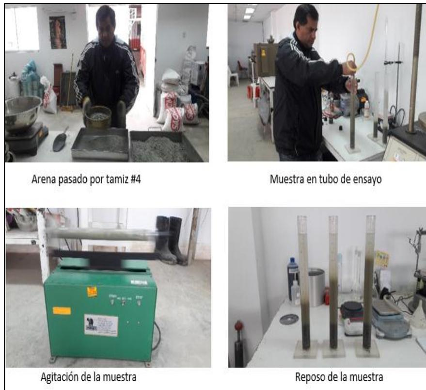
Figura 15: Ensayo de Equivalente de arena (Fuente: Elaboración propia)
