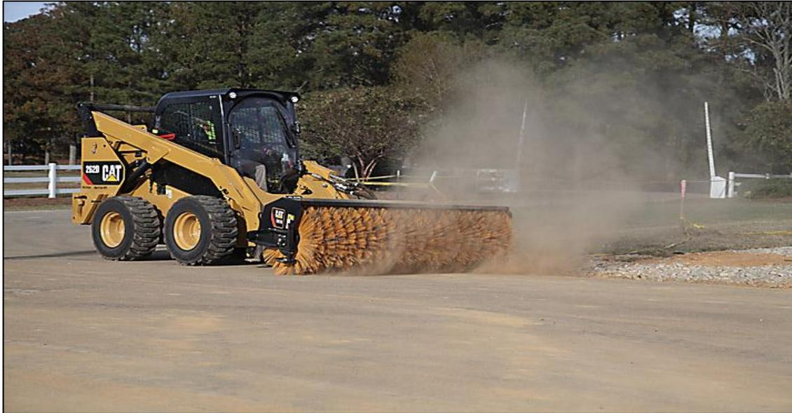
Figura 8: Diferentes tipos de barredoras mecánicas para limpieza de la vía
