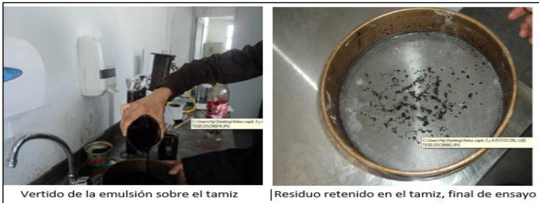
Figura 24: Ensayo de Tamizado de la emulsión asfáltica (Fuente: Emulsiones Asfálticas Ing. Gustavo Rivera)
