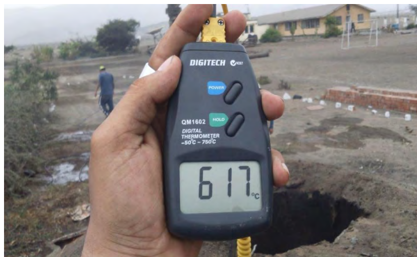
Figura N° 12 Control de la temperatura en la producción del Biocarbón.
