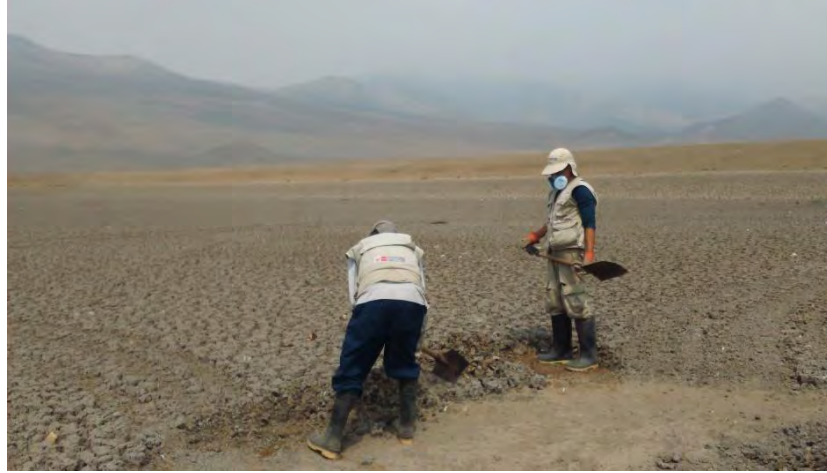
Figura N° 03 Recolección de lodos de lagunas de Oxidación (seco).
