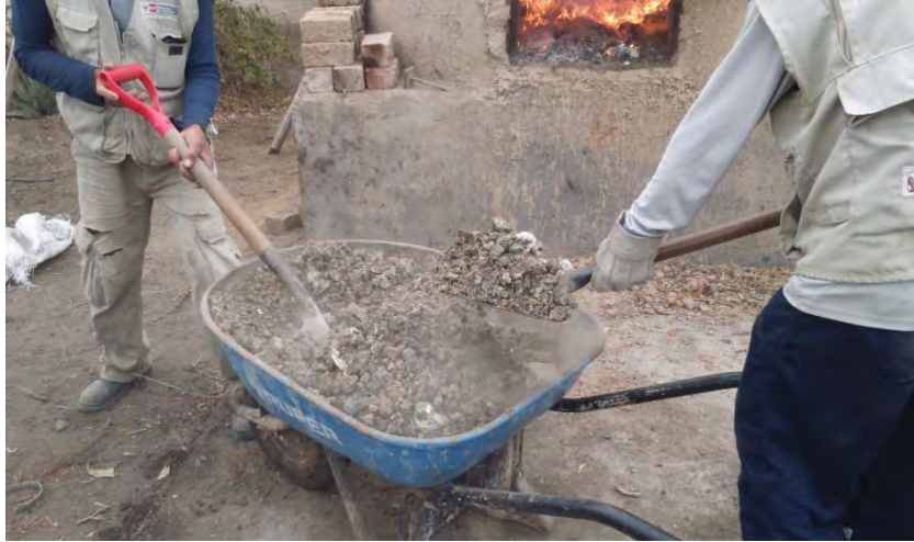
Figura N° 10 Ingreso de lodos de lagunas de oxidación al Horno
