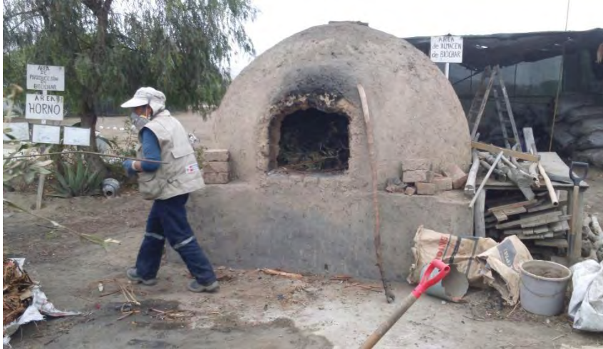
Figura N° 07 Horno Pirolítico artesanal, PEPENAR-Ancón-Lima.
