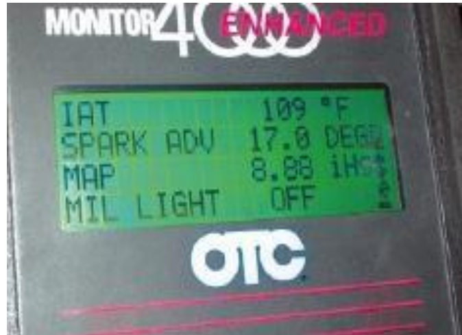
Figura 3 Monitoreo del sensor IAT a través del scanner
