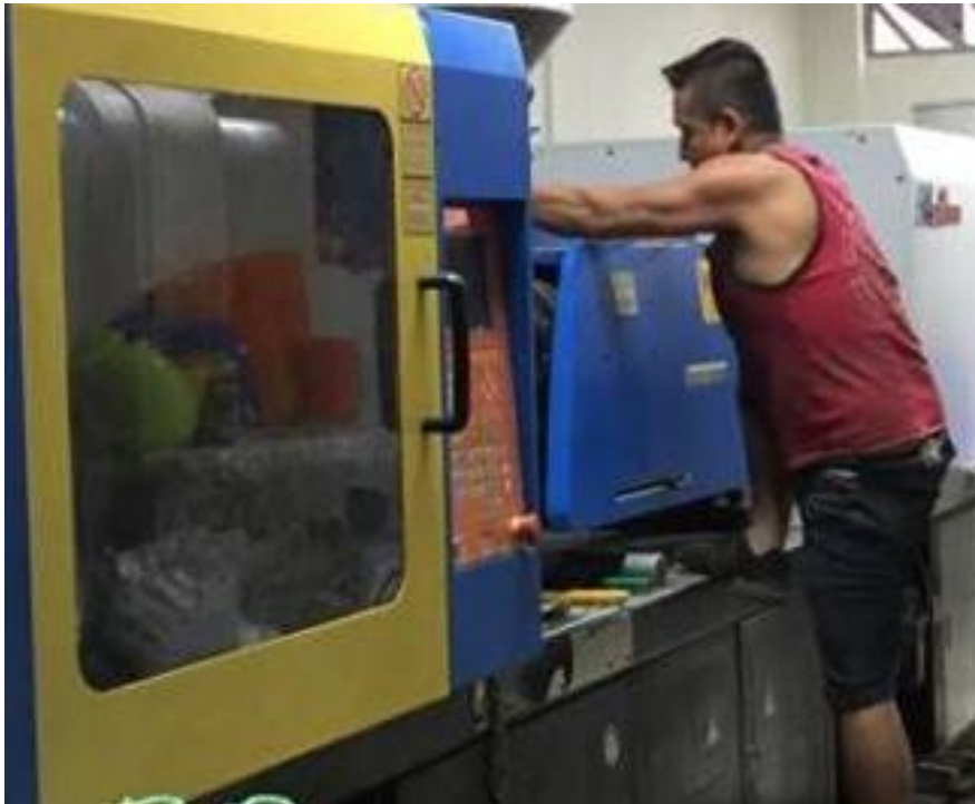
Figura 13. Trabajadores no cuentan con equipos de protección personal Fuente: Empresa Armo S.A.C.
