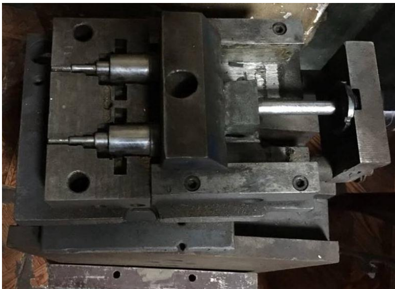
Figura 16. Matriz de inyección en el piso
