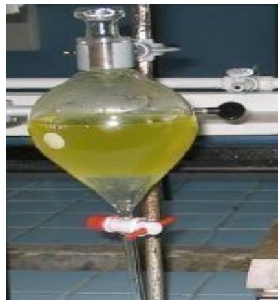
Figura 11 decantando con ayuda de un embudo de separación
